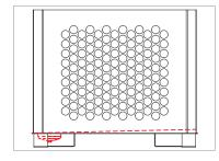
Gefälle und doppelwandige Sumpftasse optional zur optimalen Restentleerung.
