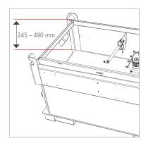
Der Staukasten hat standardmäßig eine lichte Innenhöhe von 245 mm. Darüber hinaus ist der Staukasten gegen Mehrpreis in den Höhen 330, 410 und 490 mm erhältlich. Durchführungen können beliebig platziert werden.
